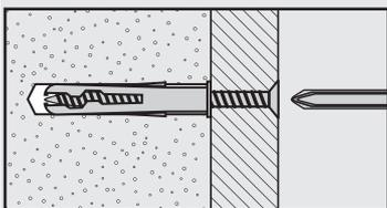
Der Spreizdübel ist im Grunde ein Spezialdübel, denn er kann nur bei Vollmauerwerk eingesetzt werden.
