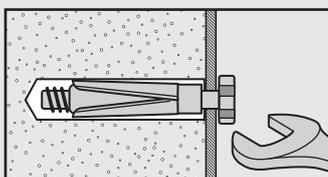
Der Messingdübel - manchmal auch Schwerlastdübel genannt - ist ein Gewinde für metrische Schrauben, das in die Mauer eingebracht wird.
