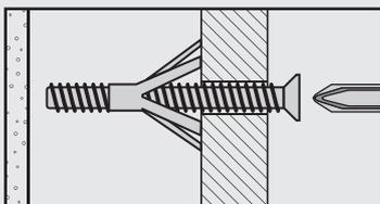
Sie sind ideal zur Befestigung hoher Lasten mit metrischen Schrauben geeignet.
